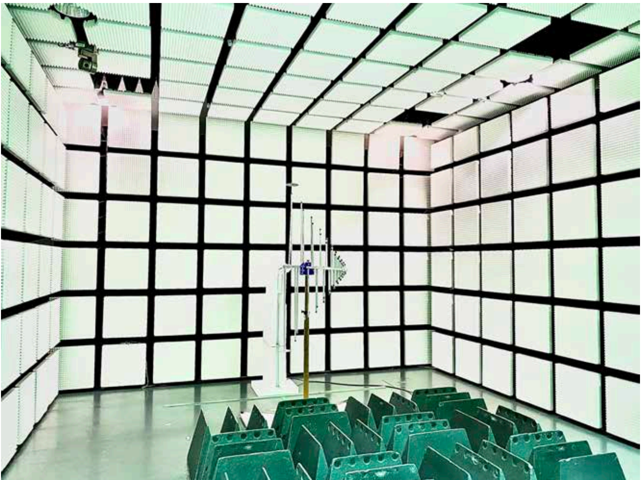
전자파 방사 내성 테스트(무반사실에 설치된 방사 안테나)
